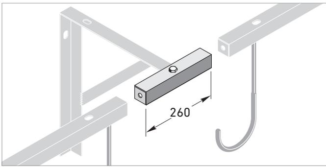
Élément de liaison pour la connexion ultérieure de plusieurs parkings suspendus en ligne. Largeur : 260 mm. Numéro d'article : 318000163
